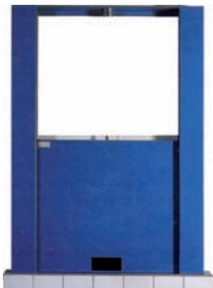
**SALISCENDI ad una ANTA** realizzata con pannello in lamiera pressopiegata a formare un sandwich coibentato, comprendente: chiusura a mezzo fusibile termico, guarnizione termoespandente e verniciatura antiruggine colore pastello con finitura semilucida non goffata.
